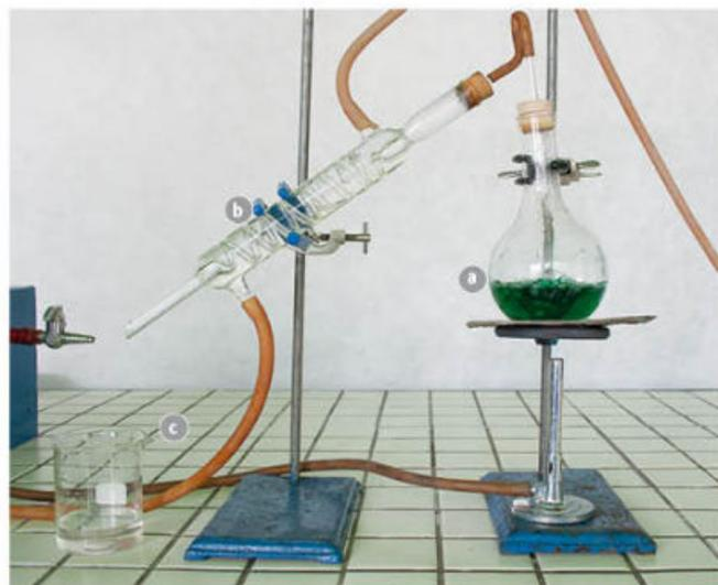
**FIGURA 29.** Para destilar es necesario calentar la disolución (a), el componente más volátil se condensa en el refrigerante (b), con lo que podemos separar este componente (c).
