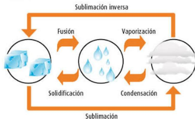
**FIGURA 15.** El estado de agregación de una sustancia es una propiedad cualitativa, pero las condiciones en que ocurren los cambios de fase (presión y temperatura) son propiedades cuantitativas.
