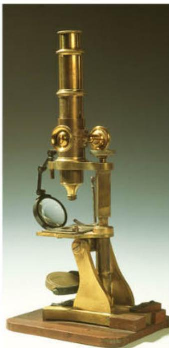
**FIGURA 17.** El microscopio óptico es un instrumento hecho a base de lentes, que permite observar la imagen aumentada del objeto que nos interesa estudiar.
