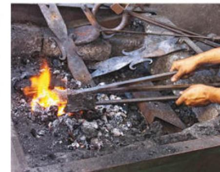
**FIGURA 24.** Todos los materiales metálicos son maleables, aunque unos lo son más que otros, por ejemplo, el plomo o el oro se pueden moldear con un martillo a la temperatura ambiente, mientras que para moldear hierro es necesario calentarlo mucho.
