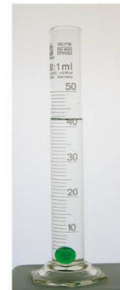
**FIGURA 13.** El volumen de un sólido se puede conocer por el volumen de líquido que desplaza.
