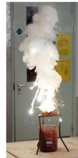
**FIGURA 16.** La reacción de termita o aluminotermia produce hierro fundido debido a que la temperatura de la reacción se eleva por encima de los 2000 °C, por lo que suele utilizarse para unir las vías de los trenes que viajan a alta velocidad.
