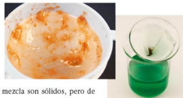
FIGURA 24. La filtración separa dos materiales con base en el tamaño de sus partículas.
