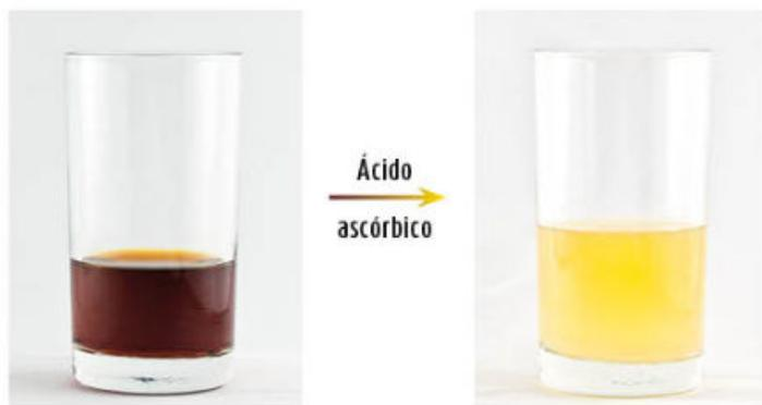
FIGURA 19. En presencia de un agente reductor como el ácido ascórbico, el yodo sufre una transformación química que podemos apreciar por el cambio de color.
