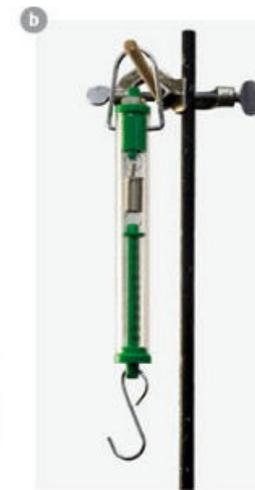
**FIGURA 11.** Las balanzas (a) y los dinamómetros (b) son instrumentos para medir la masa de los objetos, directa o indirectamente. ¿Sabes cómo usarlos?
