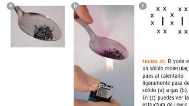
FIGURA 45. El yodo es un sólido molecular, pues al calentarlo ligeramente pasa de sólido (a) a gas (b). En (c) puedes ver la estructura de Lewis.
