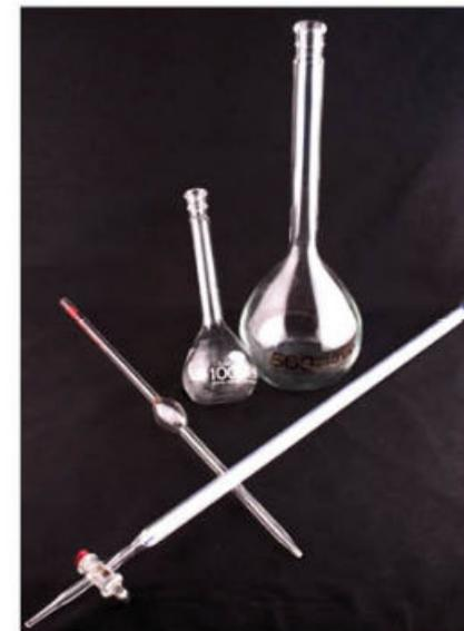
**FIGURA 12.** En el laboratorio se utiliza material de vidrio, graduado, para conocer el volumen de los materiales líquidos.
