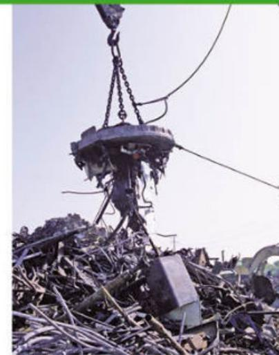
**FIGURA 27.** La magnetización permite separar fácilmente el acero de otros metales.
