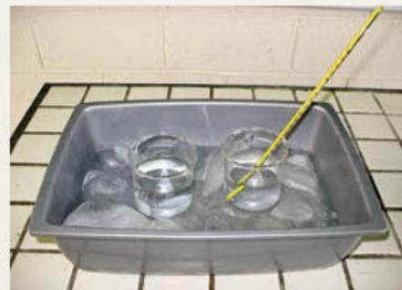
d. Anoten en su cuaderno lo que esperan que le suceda a cada una de las muestras al sumergirlas en el baño frío. Ahora introduzcan en el baño frío cada uno de los tubos de ensaye que contienen las muestras. Esperen de 5 a 10 minutos. Registren la temperatura y el estado de agregación de cada una de las muestras.
